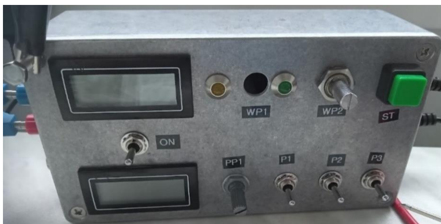
Obr. 16: Přístroj pro řízení proudu pro výrobu wolframových hrotů.
