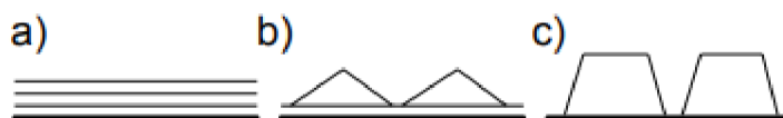
Obr. 6: Ilustrace typů termodynamicky ovlivňovaného růstu tenkých vrstev při heteroepitaxi. Vrstva po vrstvě (a), kombinovaný růst (b) a ostrůvkový růst (c). Převzato z [18]
