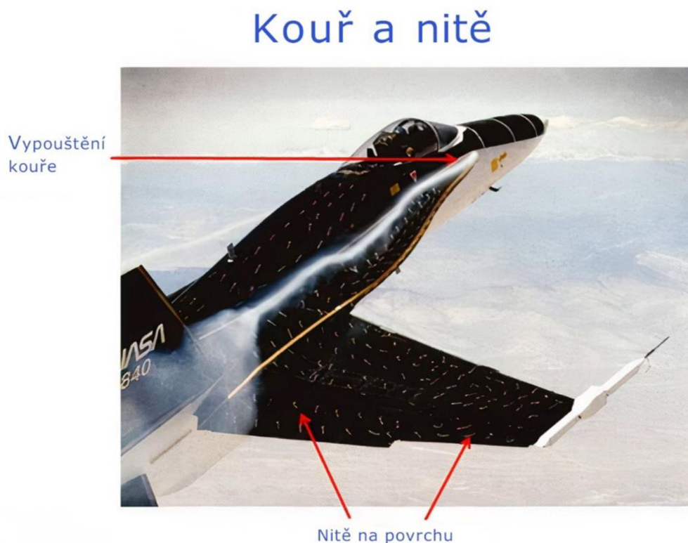
Obr. 2: Vizualizace proudění za pomoci kouře a nití [10] - upraveno
