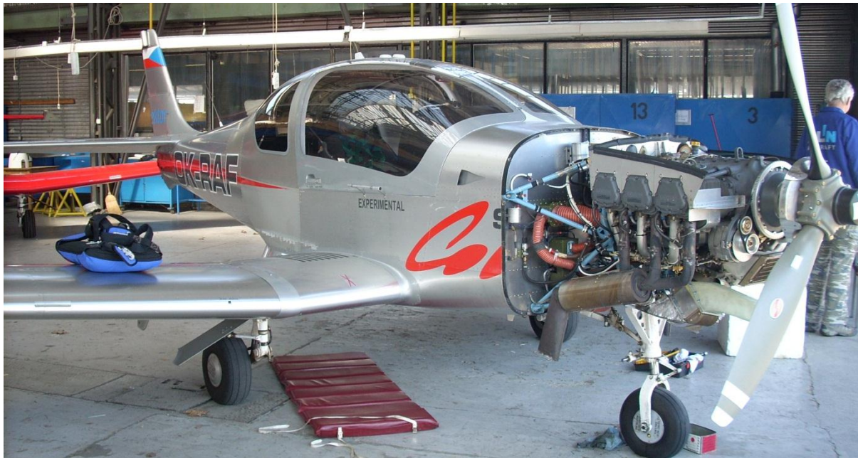
Obr. 10: VUT100-131i Cobra s odmontovaným krytem motoru při prohlídce
