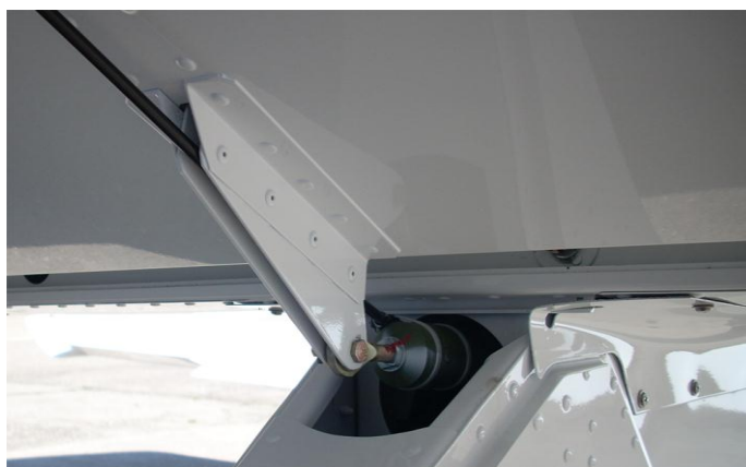
Obr. 5: Ovládací zařízení výškového kormidla letounu Zlín Z-242L
