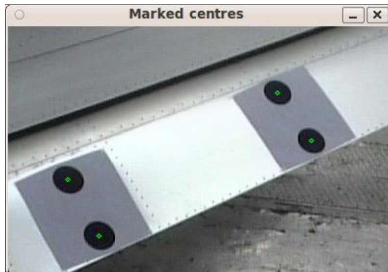
Obr. 13: Klapka s vyznačenými středy značek
