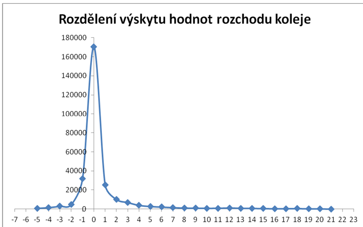
Graf 1 Rozdělení četnosti výskytu odchylek rozchodu koleje - parametr RK100 (osa x odchylka [mm]; osa y - četnost odchylek)
