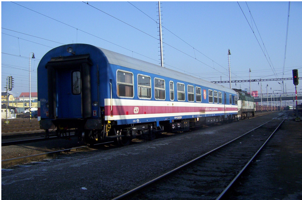
Obrázek 191 Měřicí vůz TUDC (foto SŽDC TÚDC)
