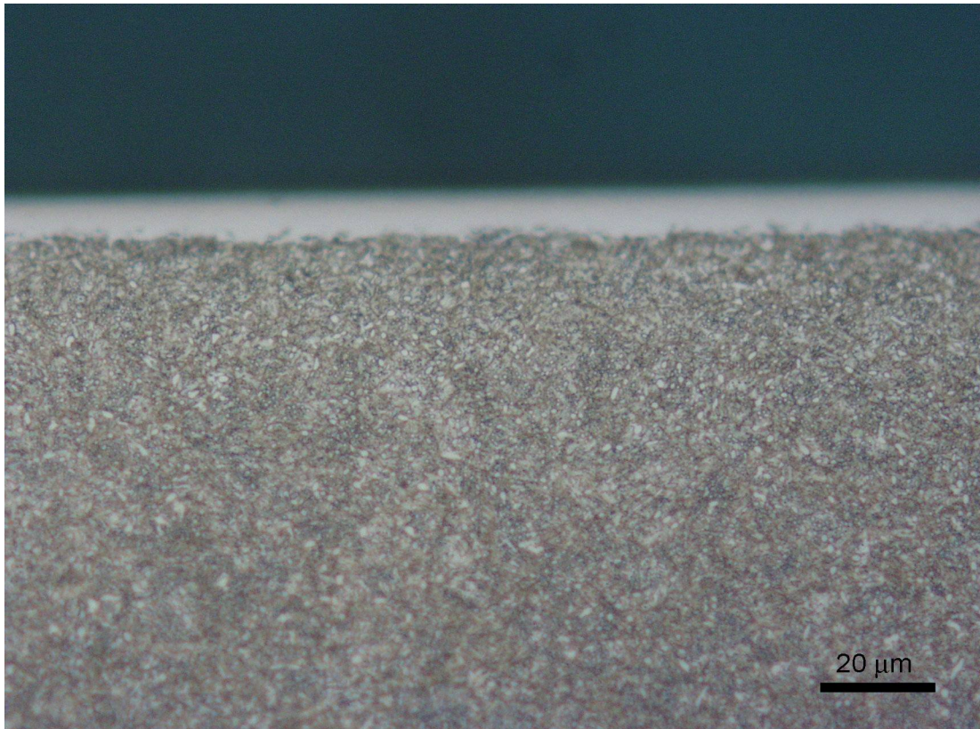
Obr. 4.7 Vzhled iontově nitridované vrstvy v řezu, IN1, 510 °C/20 hod., Nital
