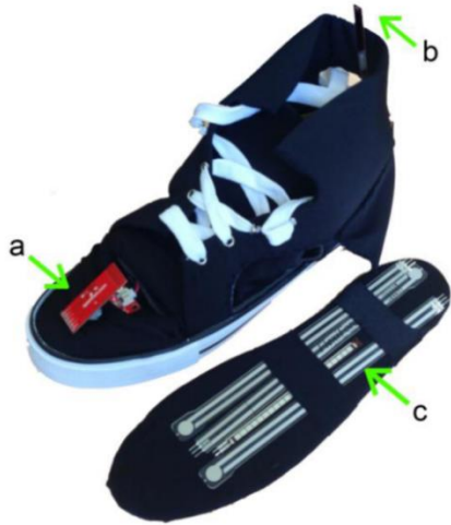
Obrázek 2. Přístrojová bota: a) inerciální měřicí jednotka, b) flexibilní goniometr, c) tlakové senzory, které jsou umístěny uvnitř stélky (Muro-de-la-herran et al., 2014).
