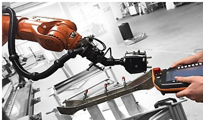
Obr. 21) Robot s 3D skenerem při využití Leica Absolute Tracker AT901 [30]
