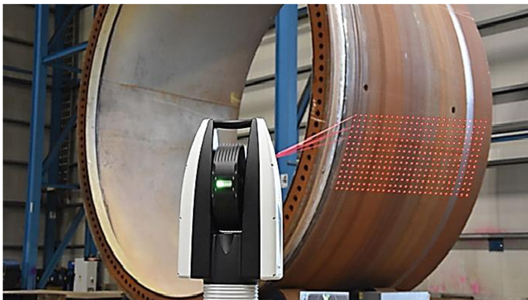
Obr. 22) Grafické znázornění sítě bodů trackeru s přímým skenováním [31]
