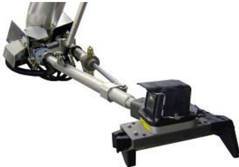
Obrázek 1.2: Hydraulické rameno DeLaval VMS (Moso.cz, 2022)
