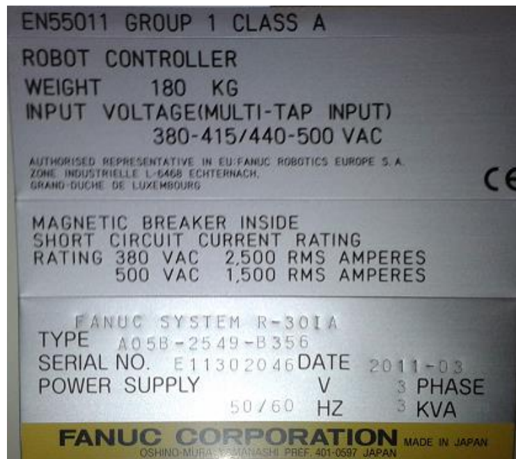
Obr. 10: Výrobní štítek kontroléru robota FANUC M-20iA [23]
