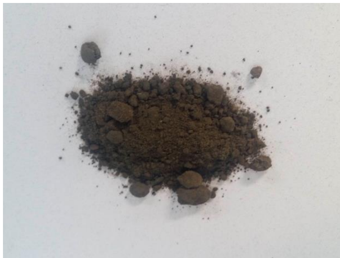
Obr. č. 2 – Sušený čistírenský kal z kontaktní lopatkové sušárny (Raček a kol. 2018)
