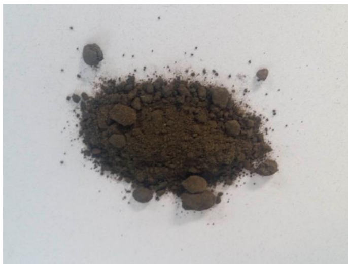
Obr. č. 2 – Sušený čistírenský kal z kontaktní lopatkové sušárny (Raček a kol. 2018)
