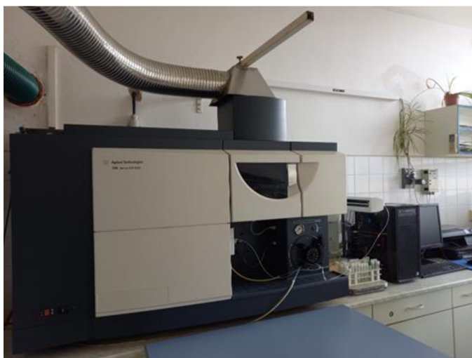
Obr. č. 8 – Optický emisní spektrometr s indukčně vázanou plazmou (ICP-OES)
