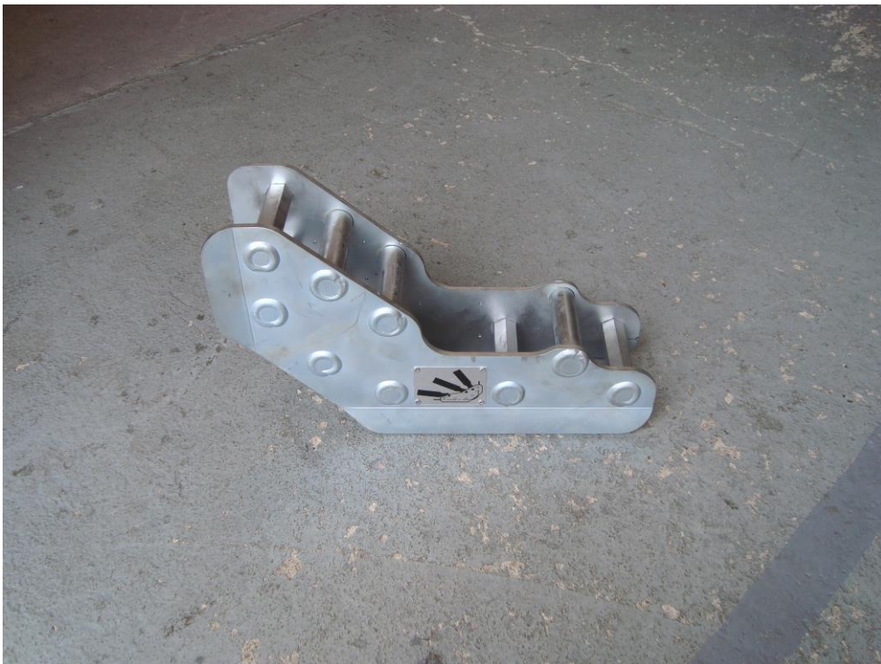
Obrázek 10 Prahová opěrka [foto - autor BP]
