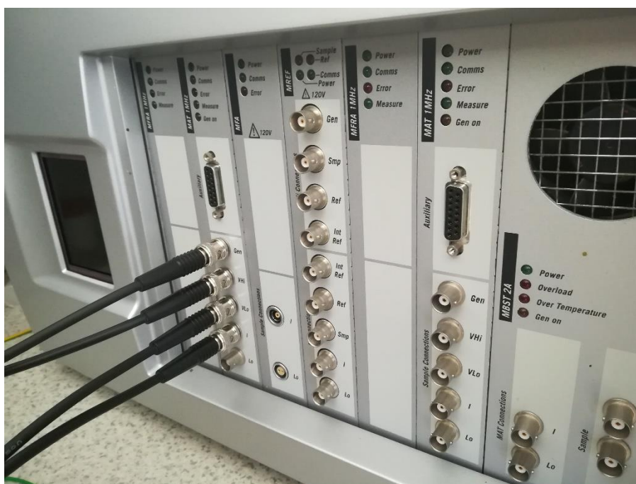
Obr. 5-2 Zapojení měřicího přístroje ModuLab XM MTS
