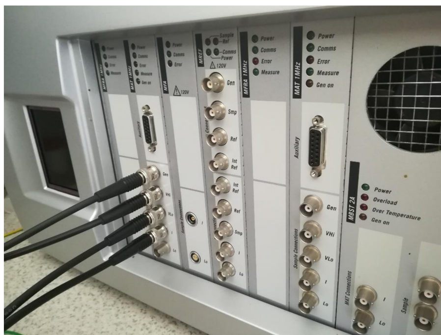
Obr. 5-2 Zapojení měřicího přístroje ModuLab XM MTS
