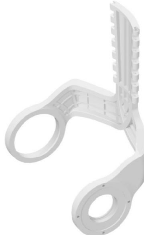
Obr. 29 Stehenní část - vezre s kloubem
