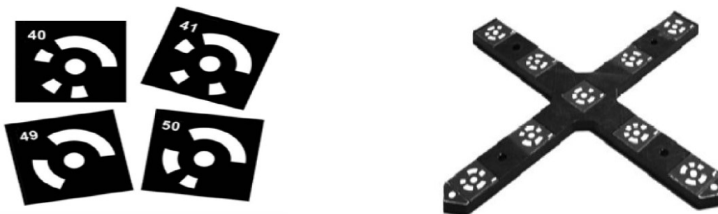
Obrázek 4 - Kódované referenční značky pro systém TRITOP [7]
