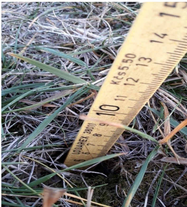
Obrázek 9: Prasklina v zemi způsobená počasím v průběhu sezóny – foceno 17. 10. 2018 (foto: Doskočil)
