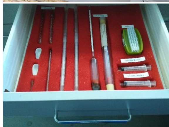
obr. 10 Při využití shadowboardu snadno poznáme, že něco chybí, zdroj: Rheinmetall Automotive
