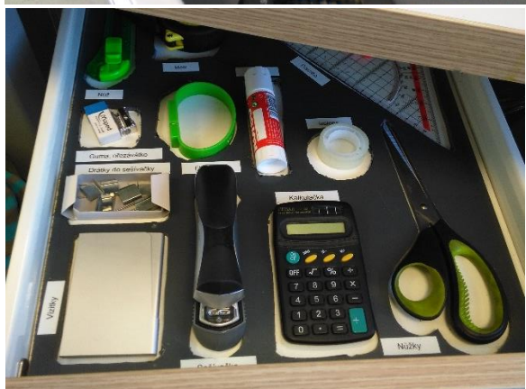
obr. 10 Při využití shadowboardu snadno poznáme, že něco chybí, zdroj: Rheinmetall Automotive
