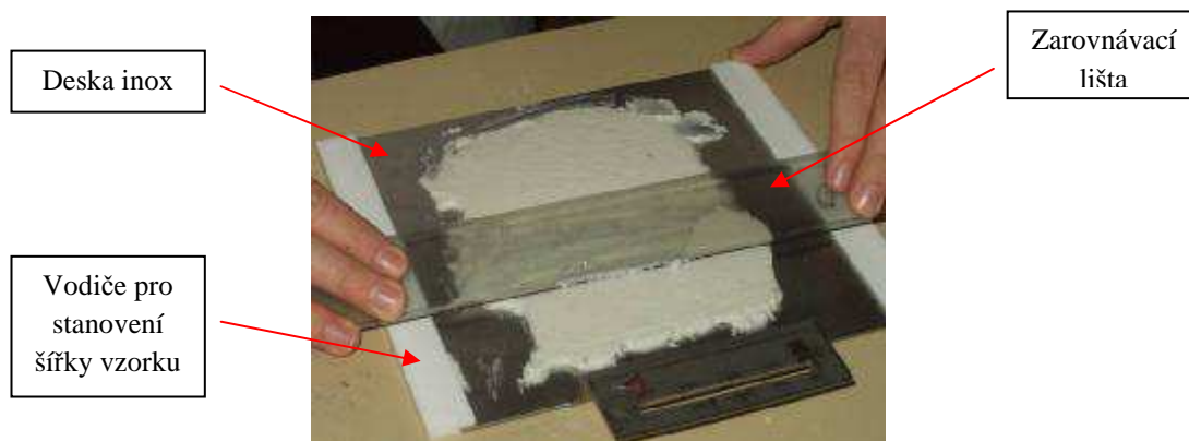
Obr. 4.2.1 – Fotografie nanášení vzorku na pomocnou desku inox
