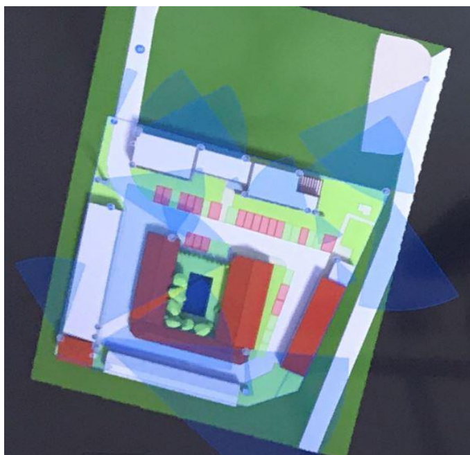
Obrázek 32 Pokrytí areálu kamerami systémem PD
