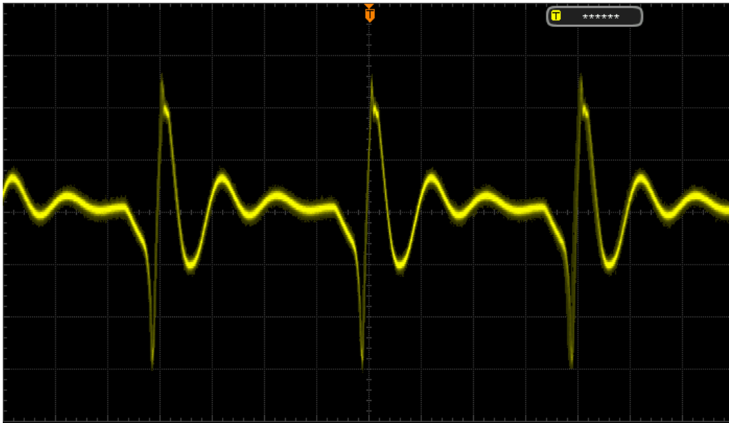
Obrázek 5.10: Kmitání zátěže CC bez úprav 20 \mu\text{s} /dílek, 200 mV/dílek
