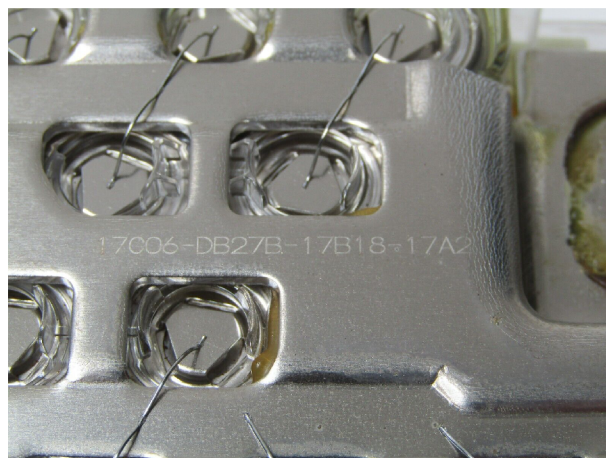
Obrázek 2.10: Připojení článků sloužící i jako pojistky v baterii z automobilu TESLA [36]
