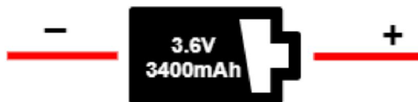
Obrázek 2.1: Zapojení baterie s jedním článkem (1S) [17]
