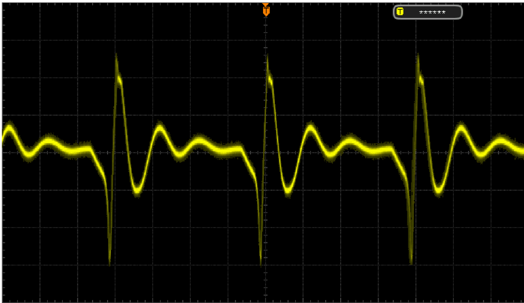
Obrázek 5.10: Kmitání zátěže CC bez úprav 20 \mu\text{s}/\text{dílek} , 200 \text{ mV}/\text{dílek}
