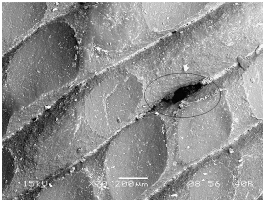
Obr. 17) Tvorba dutin mezi jednotlivými vrstvami výtisku [7]
