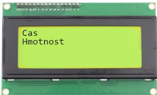
Obr. 75) Vizualizace displeje v části void setup() [44]
