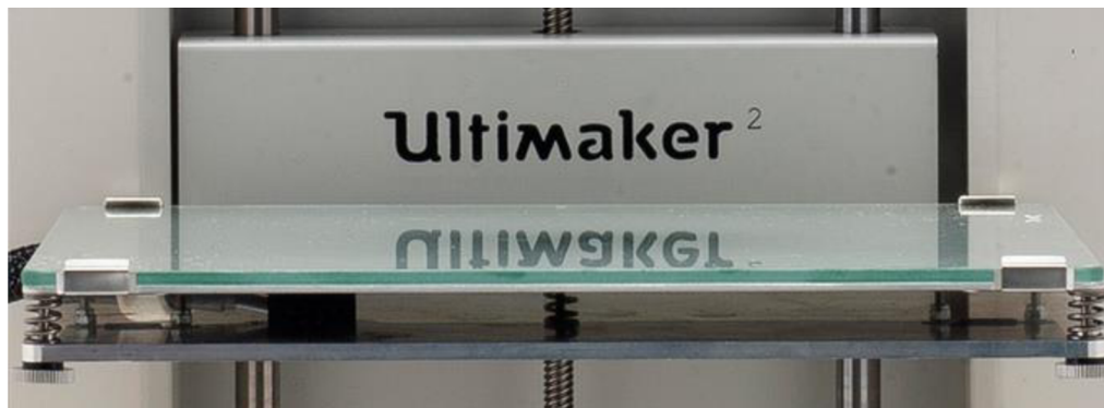
Obr. 13) Skleněná tisková podložka tiskárny Ultimaker 2 [39]
