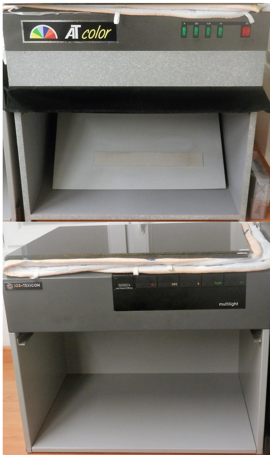
Obr. 8 Koloristické skříně, 1 - AT color, 2 - ICS – Texicon upravená pro použití s LED světelnými zdroji.
