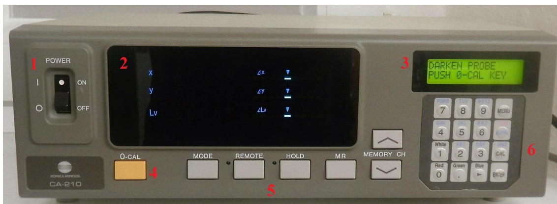
Obr. 12 Fotografie Analyzátoru Konica-Minolta CA-210 s popisem. 1 – přepínač pro vypnutí/zapnutí 2 – digitální displej 3 – LCD displej 4 – tlačítko pro počáteční kalibraci 5 – tlačítka pro změnu funkcí analyzátoru 6 – tlačítkový panel.
