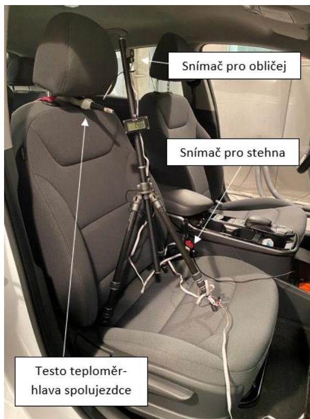
Obr.55 Umístění měřicího systému iHVAC
