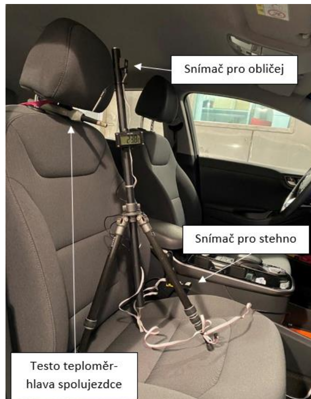
Obr. 69 Systém iHVAC uložený na sedadle spolujezdce
