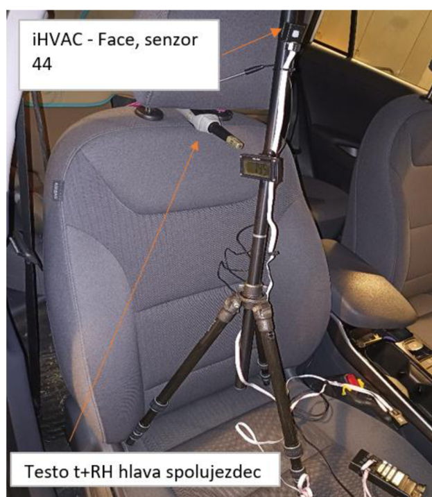
Obr.47 Nastavení měřicího systému iHVAC ve vozidle Ioniq electric
