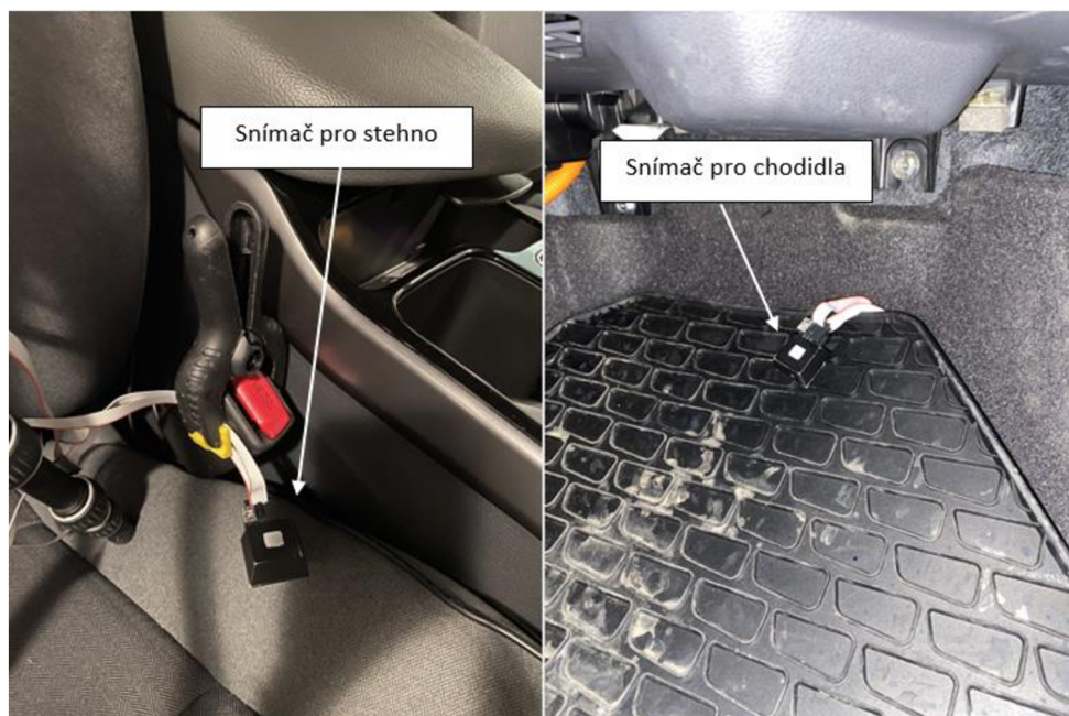
Obr.84 Umístění senzoru pro měření stehen (vlevo) a pro měření chodidel (vpravo)
