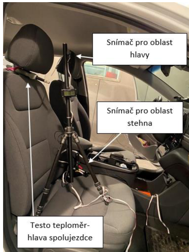
Obr.83 Zobrazení umístění iHVAC systému na vozidle spolujezdce
