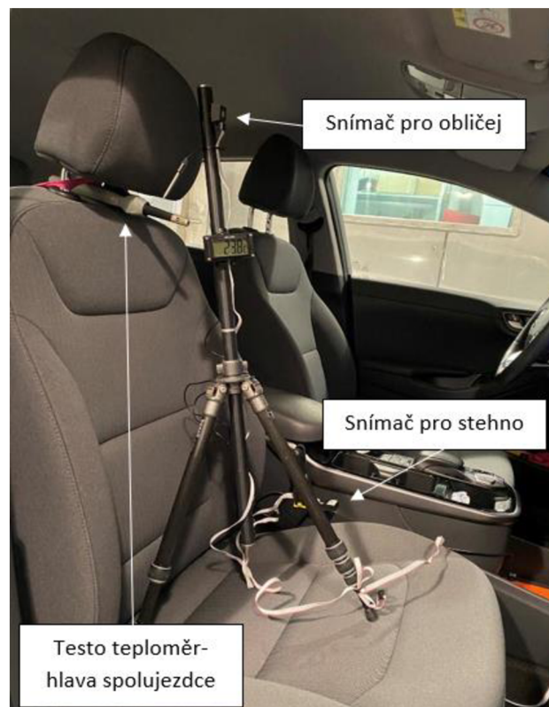
Obr. 69 Systém iHVAC uložený na sedadle spolujezdce
