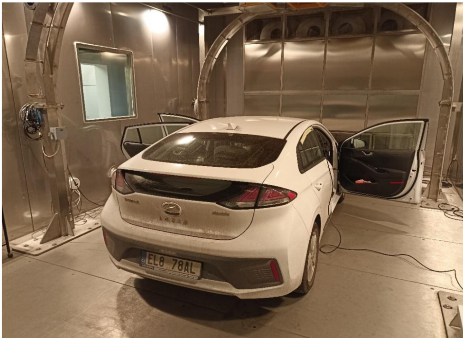
Obr. 45 Vozidlo v klimakomoře se zapojenými měřicími systémy
