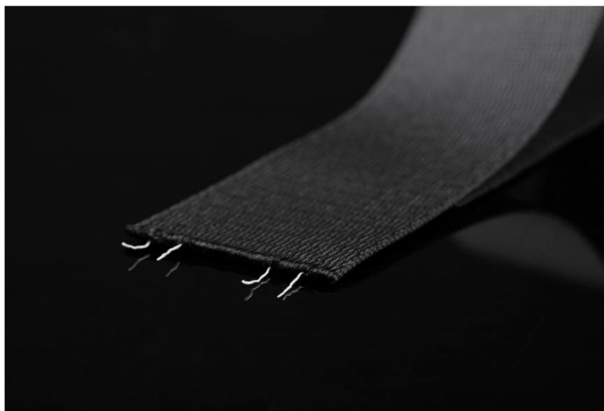
Obr.31 ukázka tepelných vodičů zabudované v pásu [53].
