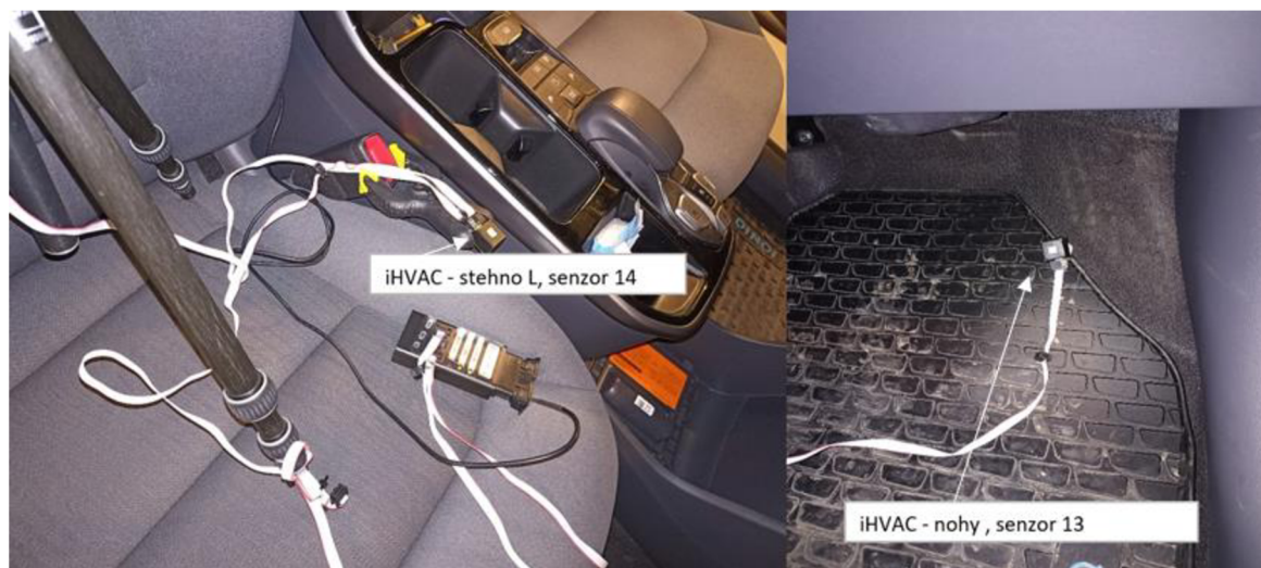
Obr.46 Nastavení senzorů 14 a 13 ve vozidle.
