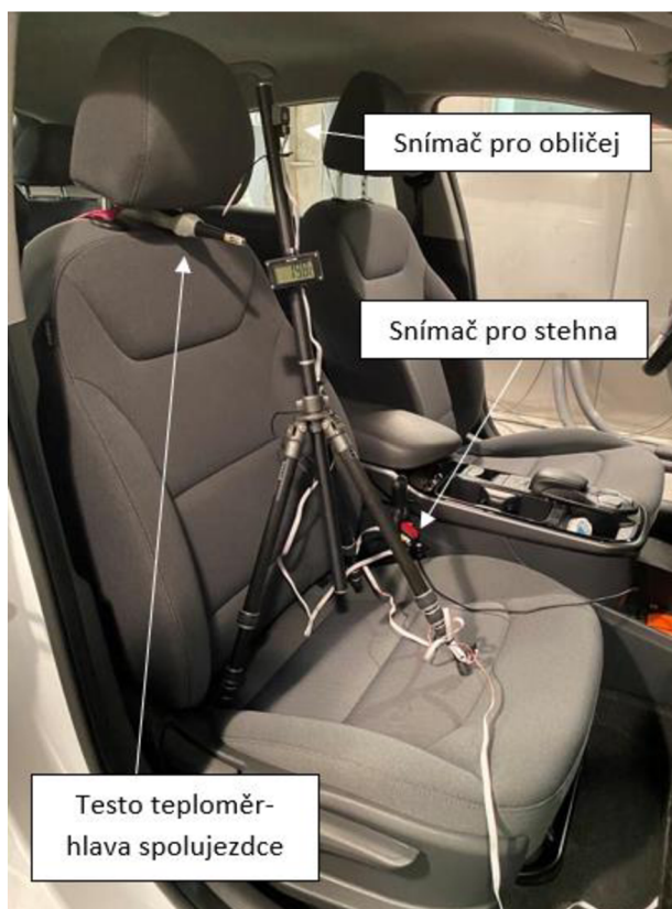
Obr.55 Umístění měřicího systému iHVAC
