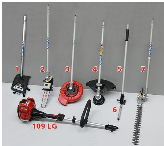
Obrázek 13 – MultiSystém: motorová jednotka Solo 109 LG, 1 – půdní kultivátor, 2 – odvětvovač, 3 – foukač, 4 – vyžínač, 5 – prodlužovací nástavec 800 mm, 6 – nástavec 210 mm pro instalaci nůžek na živý plot, 7 – nástavec s nůžkami na živý plot (Solo)
