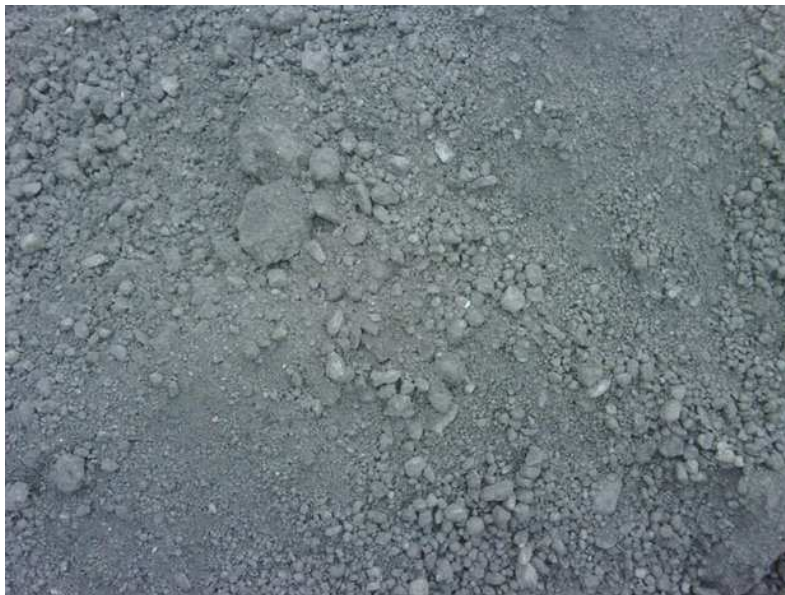
Obrázek 10 Ukázka paliva vyrobeného z kalů z Lagun Ostramo [Zdroj: www40].
