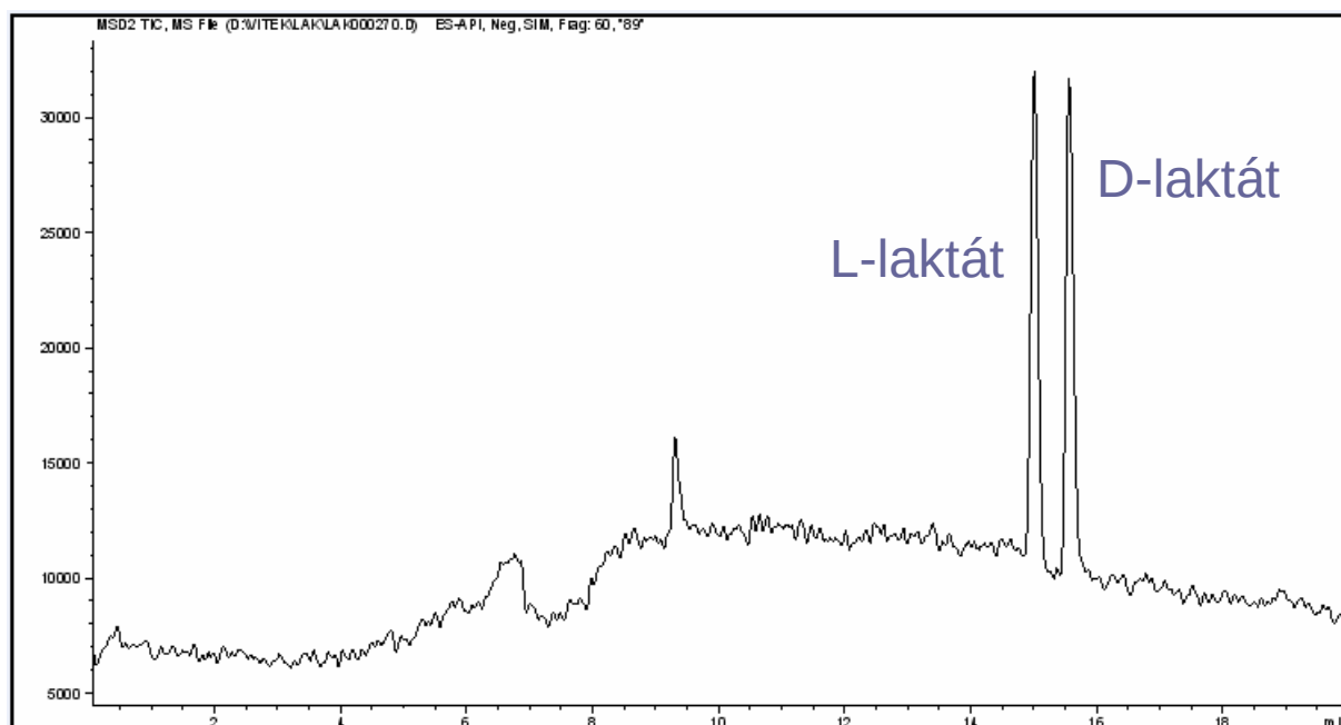
Obrázek 29: separace D- a L-laktátu u vzorku piva značky Kozel černý
