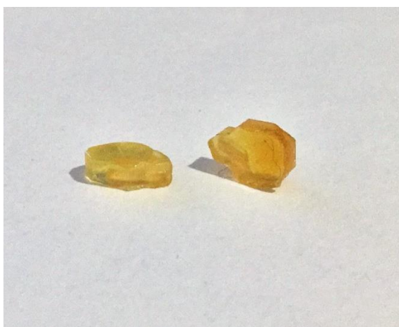
Obrázek 30: Vzorky dřeva zalité do pyramidální tvaru ve SPURR pryskyřici pro následnou úpravu.
