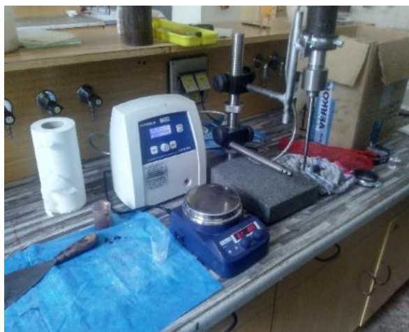
Obrázek 29: Bandelin Sonopuls HD 3200 s připojenou sondou.
