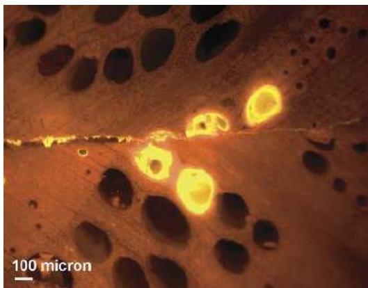
Obrázek 10: Detail PVAc lepidla v cévě dubového dřeva s emisí fluorochromu Safraninu O, převzato z [94].
