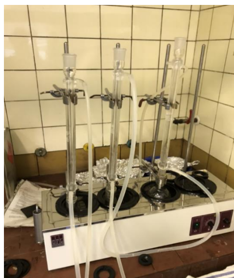
Obr. 5 Extrakce pod Liebigovým chladičem (foto: autor, 2020)
