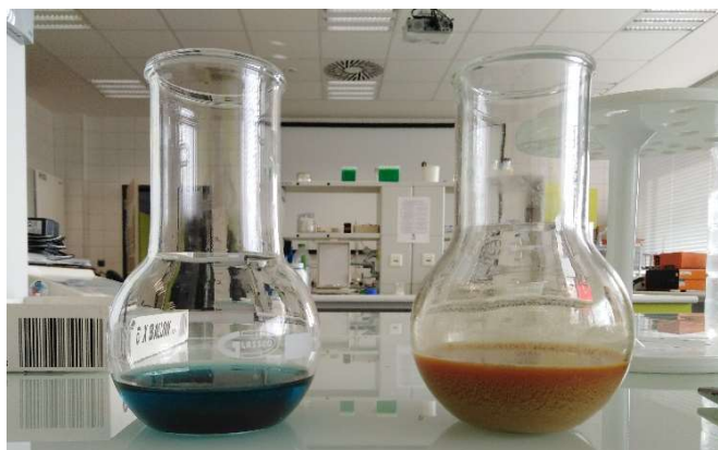
Obrázek 7: Barevné změny v průběhu stanovení. Vlevo: roztok po vyndání z vodní lázně a ochlazení. Vpravo: roztok po přidání KI a H 2 SO 4 .
