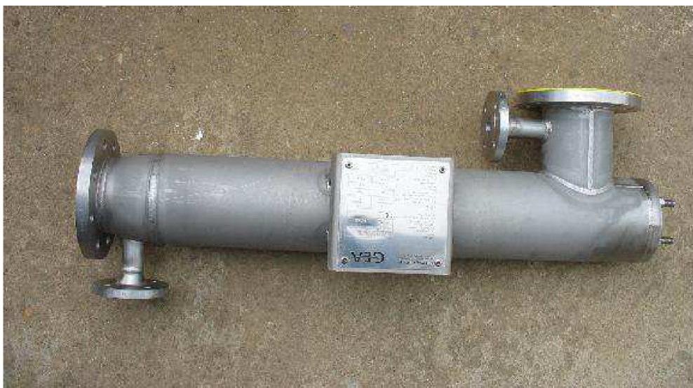
Obr. 2. Ejektor vyhříváný párou pro čerpání exhalací ze zásobníků [3].
