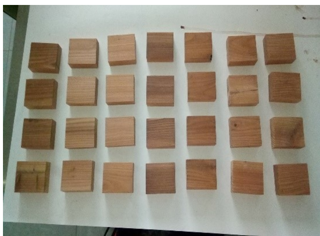
Obrázek 10 Natřené vzorky Modřínu; zdroj: vlastní zpracování
