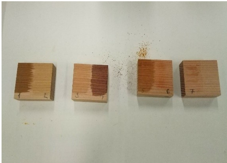
Obrázek 8 Testovací nátěr Douglaska; zdroj: vlastní zpracování
