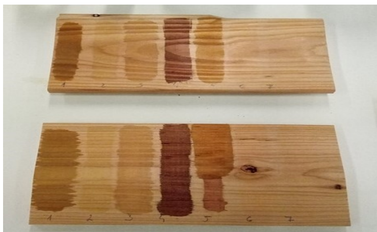
Obrázek 7 Testovací nátěr Modřín; zdroj: vlastní zpracování
