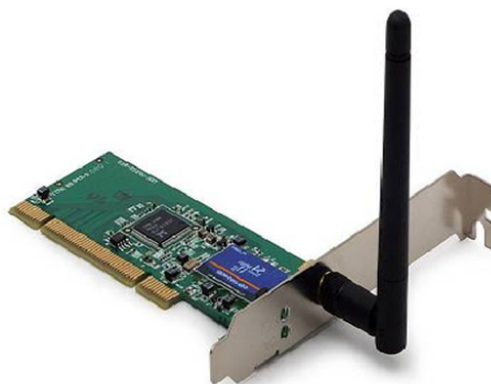
Obrázek 3-4 PCI wi-fi karta zdroj: widdayat.wordpress.com
