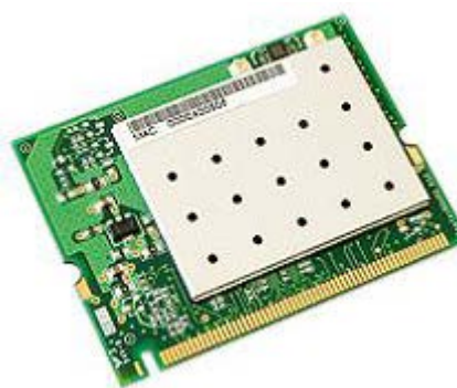
Obrázek 3-8 MiniPCI Wi-Fi karta zdroj: www.pc-houska.cz
