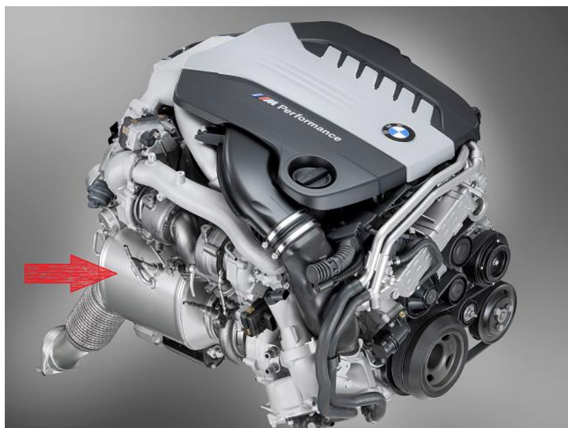
Obr. 7 Umiestnenie DPF filtra pri motore BMW [40]
