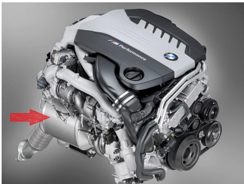
Obr. 7 Umiestnenie DPF filtra pri motore BMW [40]
