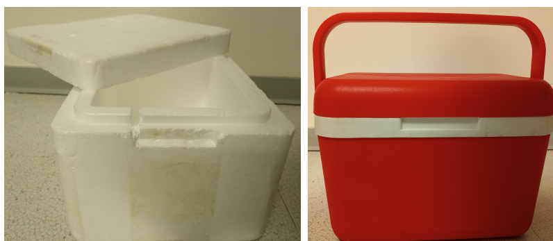
Obr. 4.2: Testovací PS box vlevo a plastový box, kde je patrné víko zabezpečené zámkovou rukojetí vpravo.
