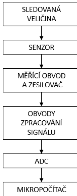
Obr. 1.1: Schéma principu činnosti senzoru, upraveno z [36].
