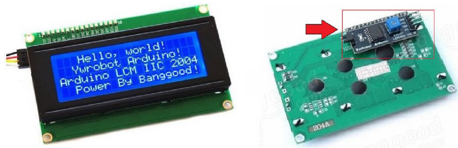
Obr. 4.9: LCD vlevo a modul převodníku na I2C vpravo, převzato a upraveno z [34].
