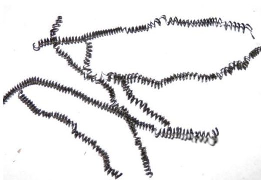
Obr. 36 Tříska při dokončování ramena s kratším čepem.
