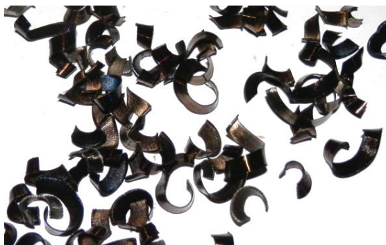
Obr. 35 Třísky při hrubování ramena s kratším čepem.
