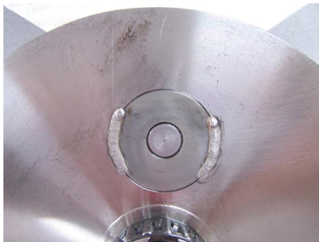
Obr. 5 Svařovaný zalomený hřídle [10].
