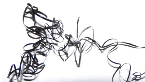
Obr. 39 Třísky při dokončování ojničního čepu.
