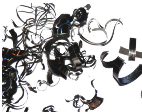
Obr. 38 Třísky při hrubování ojničního čepu.
