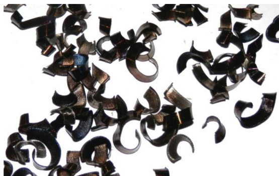
Obr. 35 Tříška při hrubování ramena s kratším čepem.
