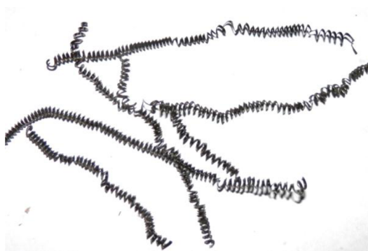
Obr. 36 Tříska při dokončování ramena s kratším čepem.
