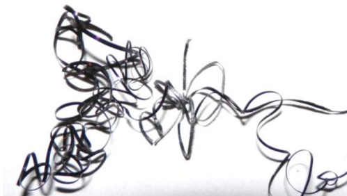
Obr. 39 Tříska při dokončování ojničního čepu.
