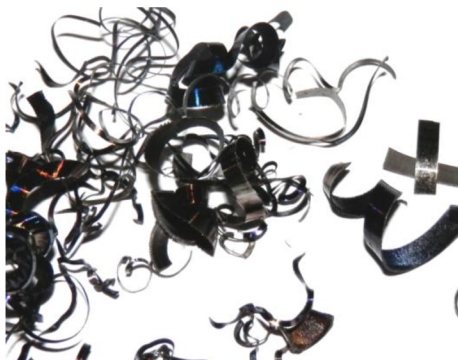
Obr. 38 Tříska při hrubování ojničního čepu.
