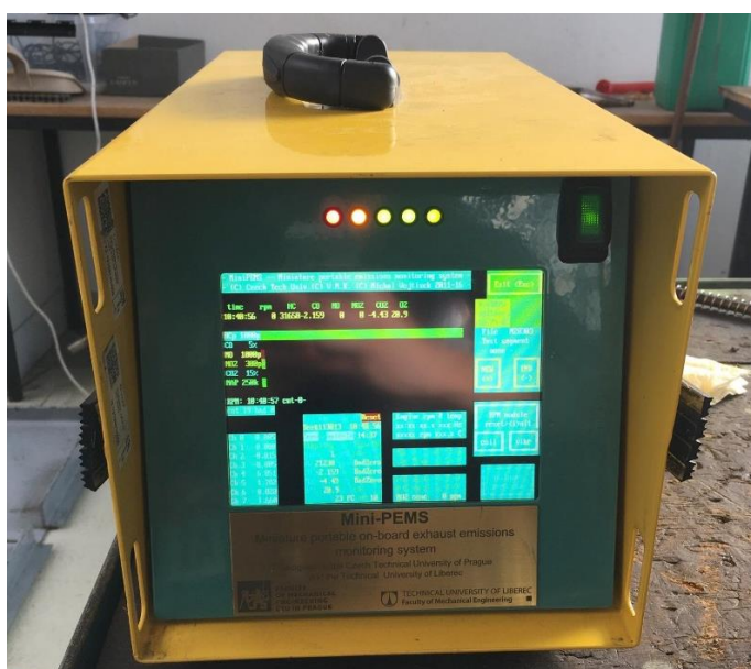
Obr. 11 Emisní analyzátor Mini – PEMS [Vlastní zdroj].
