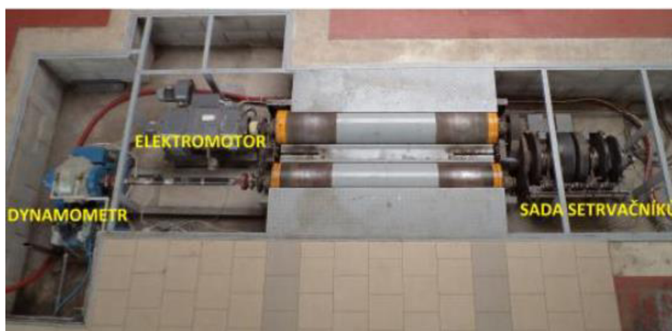
Obr. 9 Kontrukce válcové zkušebny na KVPD [30].
