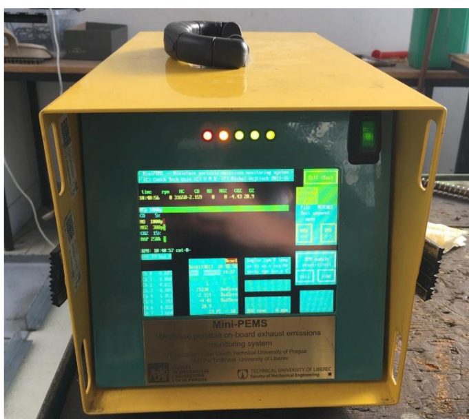
Obr. 11 Emisní analyzátor Mini – PEMS [Vlastní zdroj].
