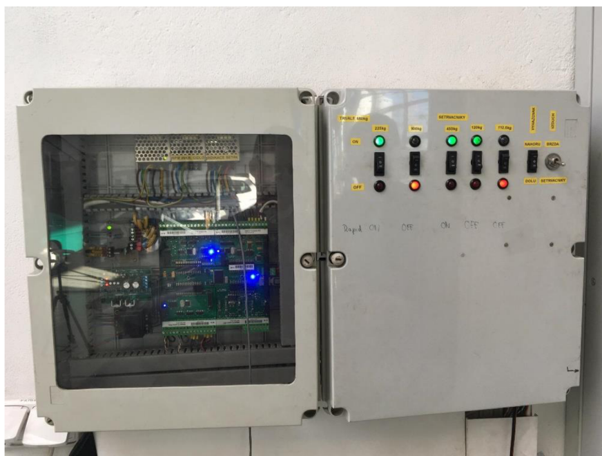
Obr. 10 Ovládací panel pro ovládání setrvačníků a válcové plošiny [vlastní zdroj].
