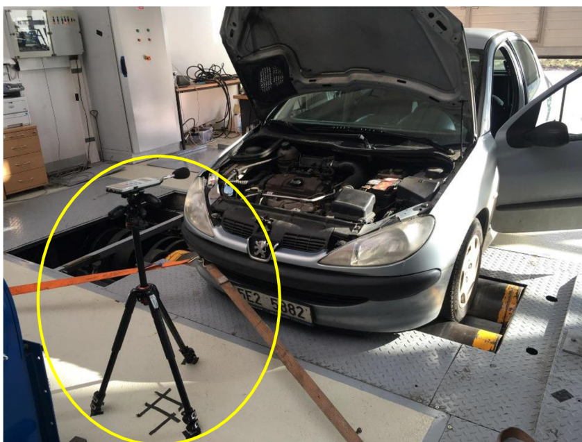
Obr. 17 Měření hluku spalovacího motoru [Vlastní zdroj].
