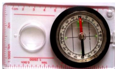
Obr. 1 Buzola je jednoduchý přístroj sloužící k orientaci v terénu, určování světových stran a měření azimutu.
