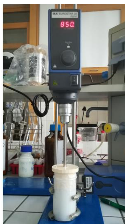
Obrázek 22: Schéma 84 a foto aparatury kulového mlýnu.
