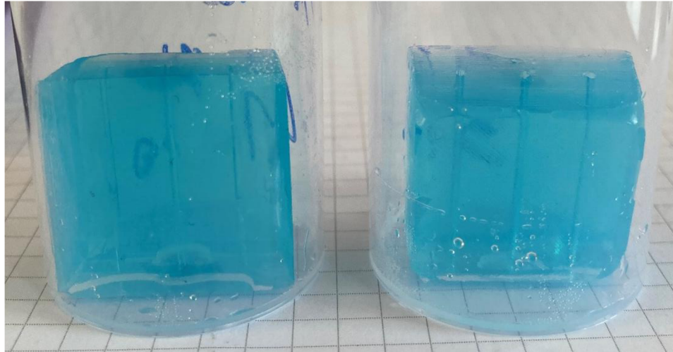
Obrázok 13: Farbivo difundovalo úspešne do celého hydrogélu typu LM 4 hm. % (vľavo) aj 3 hm. % (vpravo), zároveň kanáliky zostali stabilné aj po difúzii a 24 hodinách
