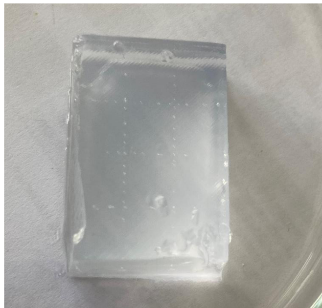
Obrázok 15: Zánik kanálikov o priemere 0,2 mm pri hydrogely z agarózy typu LM 2 hm. %
