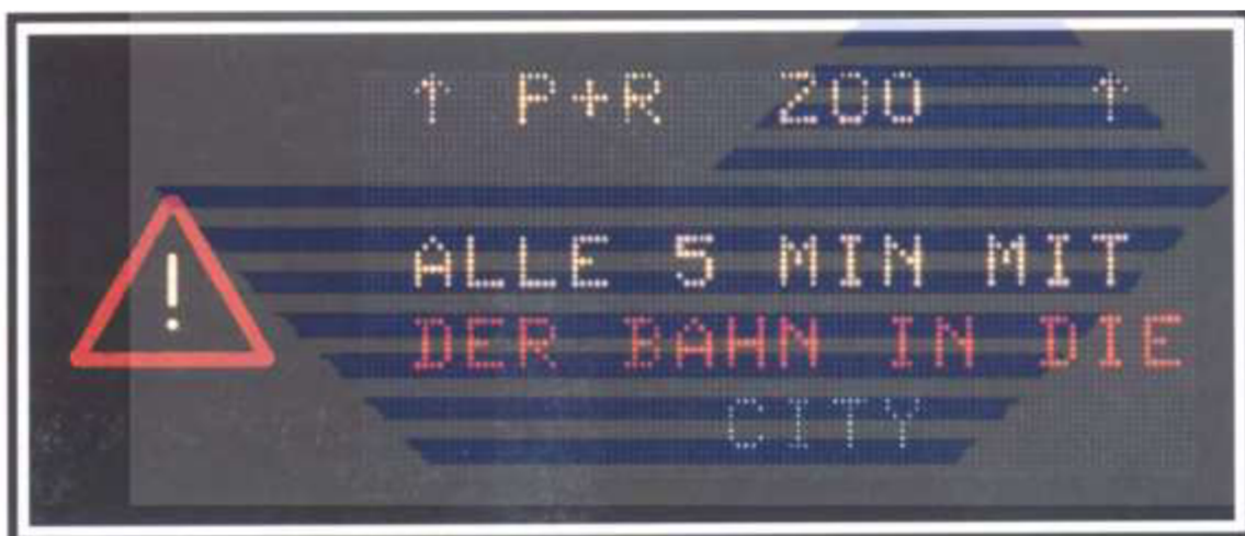
Obrázek: Proměnná textová tabule s plnou maticí bodů, text doplněn piktogramem
